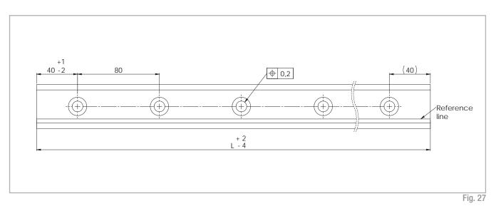
Min Max Available standard lengths L length length [mm] 160 - 240 - 320 - 400 - 480 - 560 - 640 - 720 - 800 - 880 ) - 960 - 1040 - 1120 - 1200 - 1280 - 1360 - 1440 - 1520 - 1600 - 1680 - 1760 - 1840 - 1920 - 2000 - 2080 ) - 2160 - 2240 - 2320 - 2400 - 2480 - 2560 - 2640 - 2720 - 2800 - 2880 - 2960 - 3040 - 3120 - 3200 - 3280 ) - 3360 - 3440 - 3520 - 3600 560 2000
